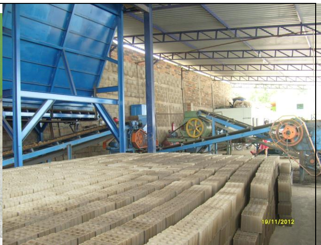
Foto 04. Rosca dosadora e correias rolantes do processo de produção.
