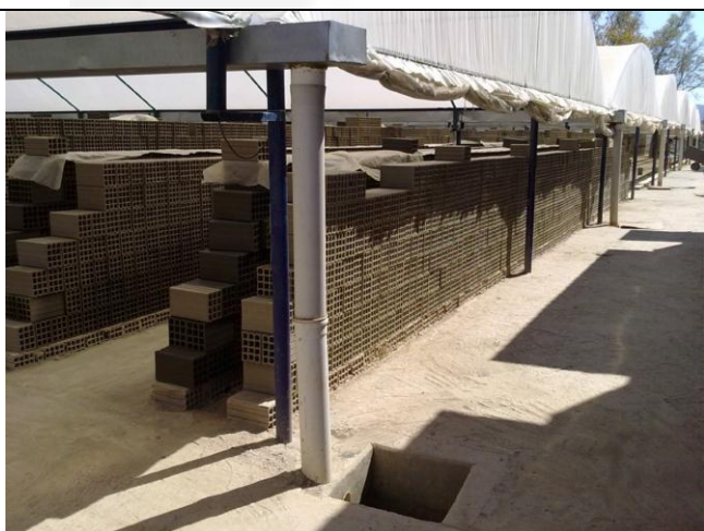
Foto 05. Estufa para secagem natural dos tijolos e sistema de drenagem pluvial constituído por canaletas e caixas de sedimentação.
