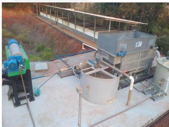
**Foto 03.** Novo flotor e decanter centrífugo.
