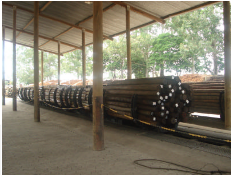
Foto 5-Madeira Preparada em Vagonetas Para Tratamento
