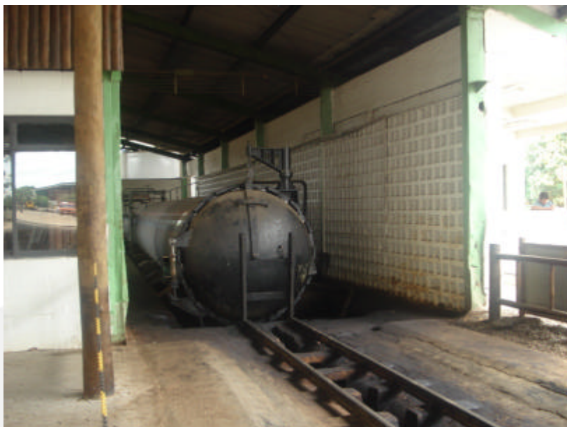
Foto 7-Autoclaves Onde é Realizado o Tratamento da Madeira
