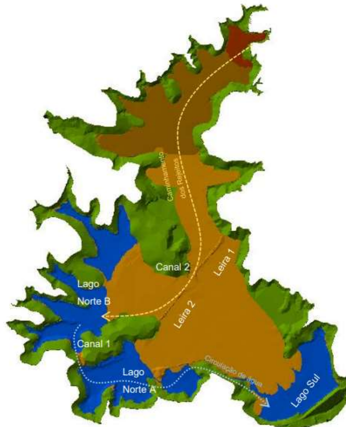
Figura 4: Esquema de manejo interno de rejeitos para expulsar o volume de água represada. EIA (Vale, 2018)
