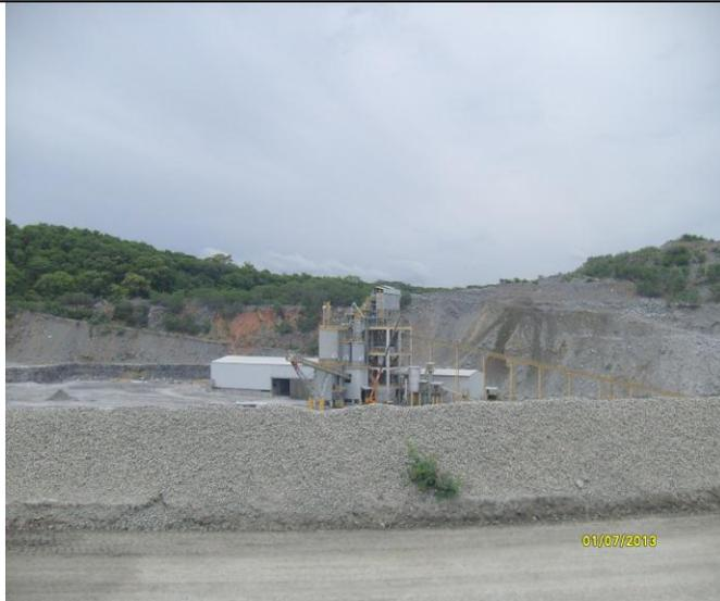
Foto 03: Planta de moagem, próxima à pilha de estéril
