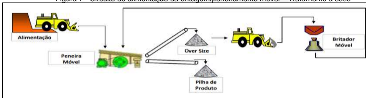
Figura 7 - Circuito de alimentação da britagem/peneiramento móvel – Tratamento a seco
