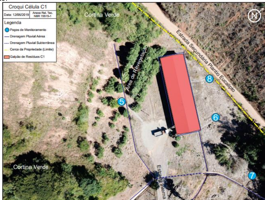
Figura 21 – Área de armazenamento de resíduos Classe I (em operação) e Aterro Classe II (encerrado) e poços de monitoramento.
