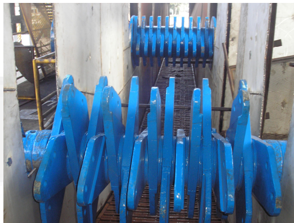
Foto 02. Colocação das Moendas.
