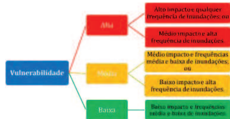
Quadro 3: Definição da vulnerabilidade à inundação de um trecho de água
