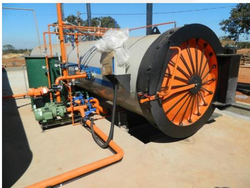
**Foto 03.** Autoclave Fhaizer de 25m³.
