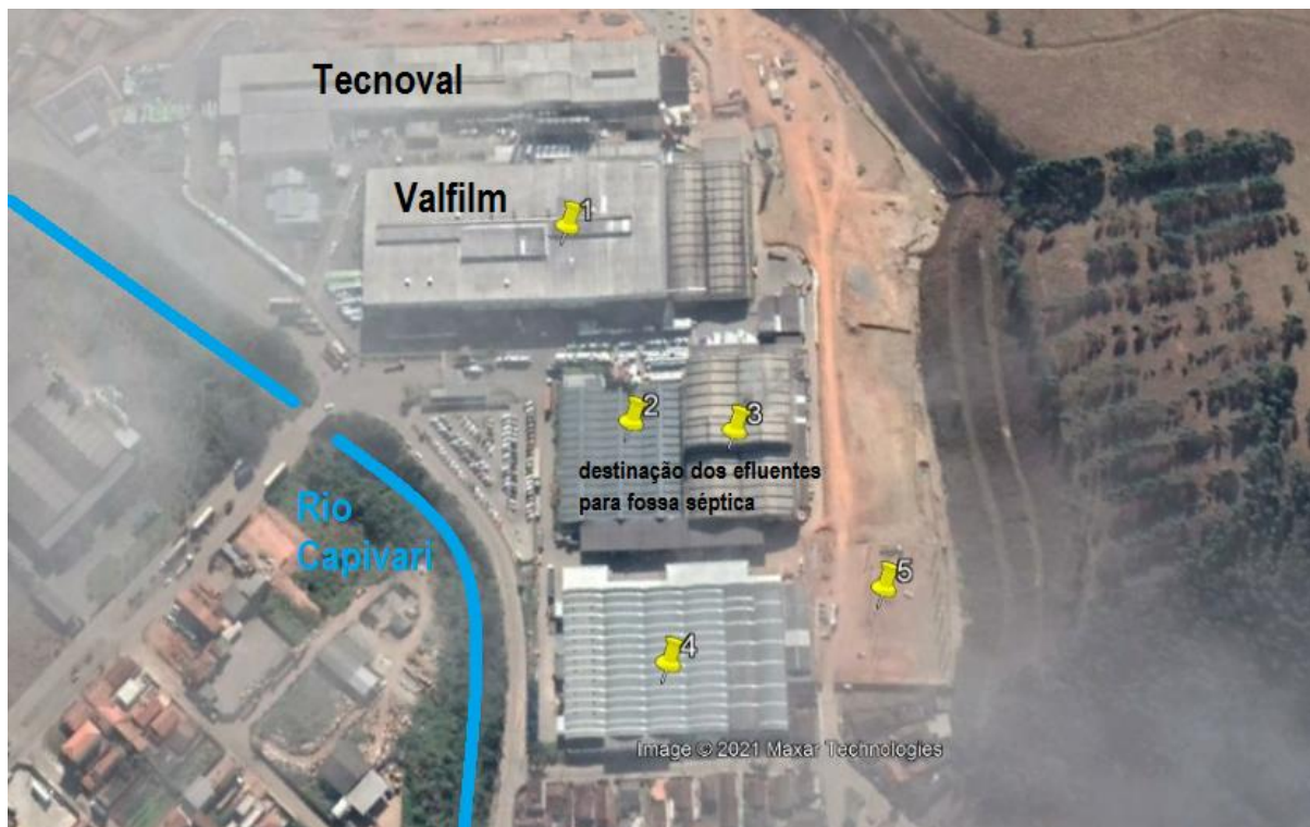
Figura 8 – Galpões da Valfilm e Tecnoval conforme as destinações dos efluentes líquidos para ETE ou Fossa Séptica – Imagem Google 07/07/2020
