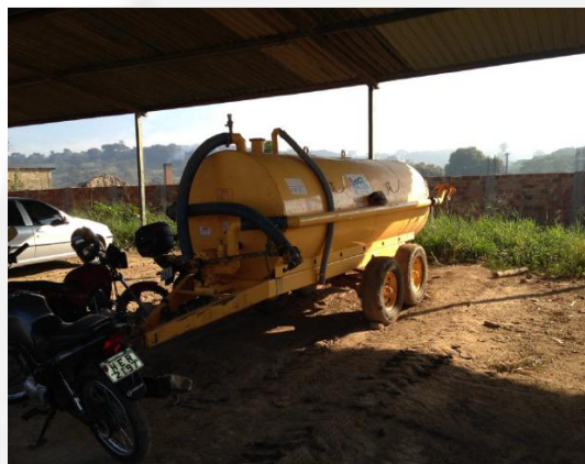
Foto 19: Caminhão pipa utilizado na aspersão.
