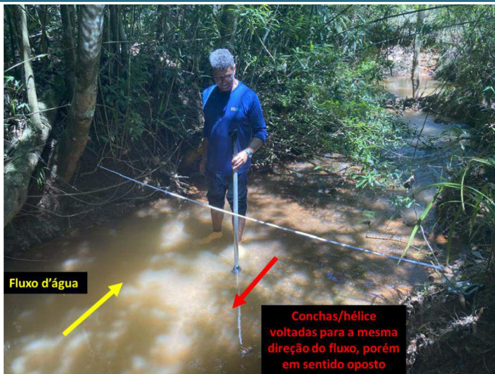
Figura 8-6: Medição de vazão com micromolinete.
