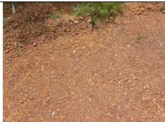
Foto Geo 17: Detalhe do material detrítico ferruginoso, laterítico associado a unidade de coberturas detríticas (colúvio-eluvionares), distribuídas aleatoriamente ao longo das áreas aplainadas da fazenda.
