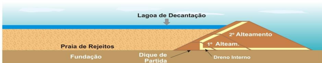
Figura 3 – Método construtivo – Alteamento à jusante
