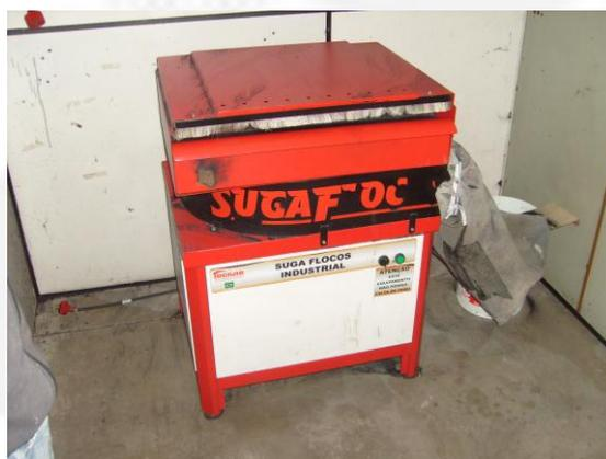
**Foto 4:** Suga-floco, utilizado no reaproveitamento dos resíduos da flocagem.
