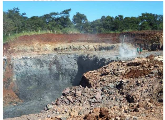
Figura 5 - Momento da perfuração da rocha para inserção dos explosivos
