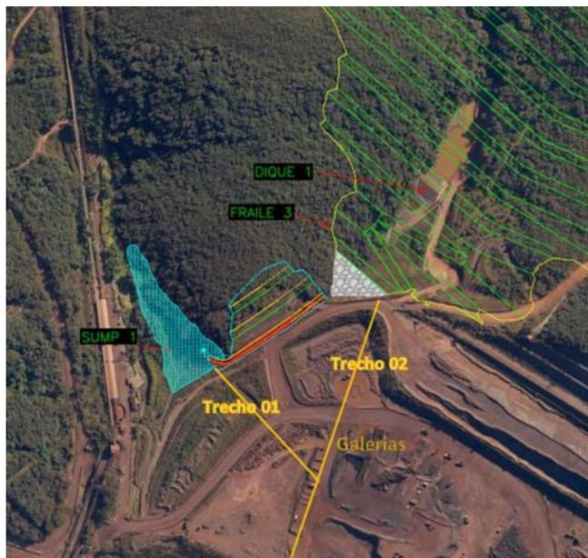
**Figura 3.6:** Pilha de rejeitos do Fraile – Fase 03 sobre o Dique 01. Indicação do Sump 01 que irá substituir a função do Dique 01. **Fonte:** Informações Complementares, 2024.
