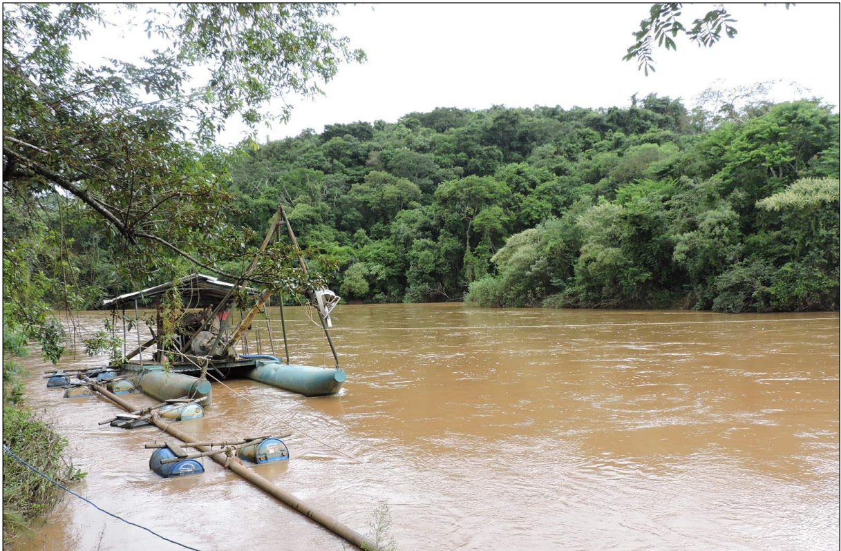
Figura 04: Outra draga utilizada no processo de extração de areia no empreendimento.
