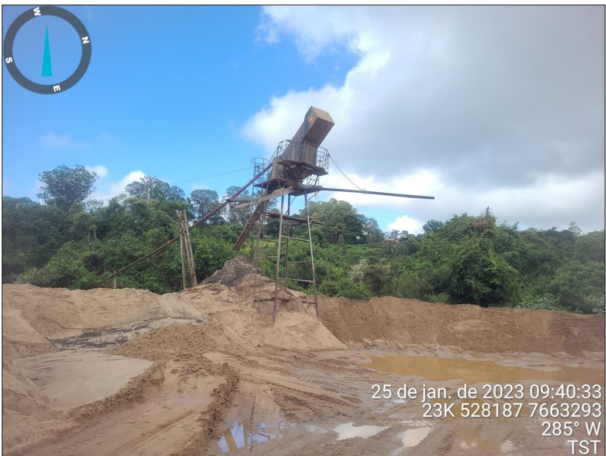
Figura 05: Peneira e classificador utilizados no Porto Fazenda Gurpiara.
