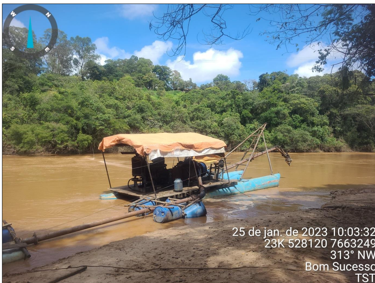
Figura 03: Draga utilizada no processo de extração de areia no empreendimento.
