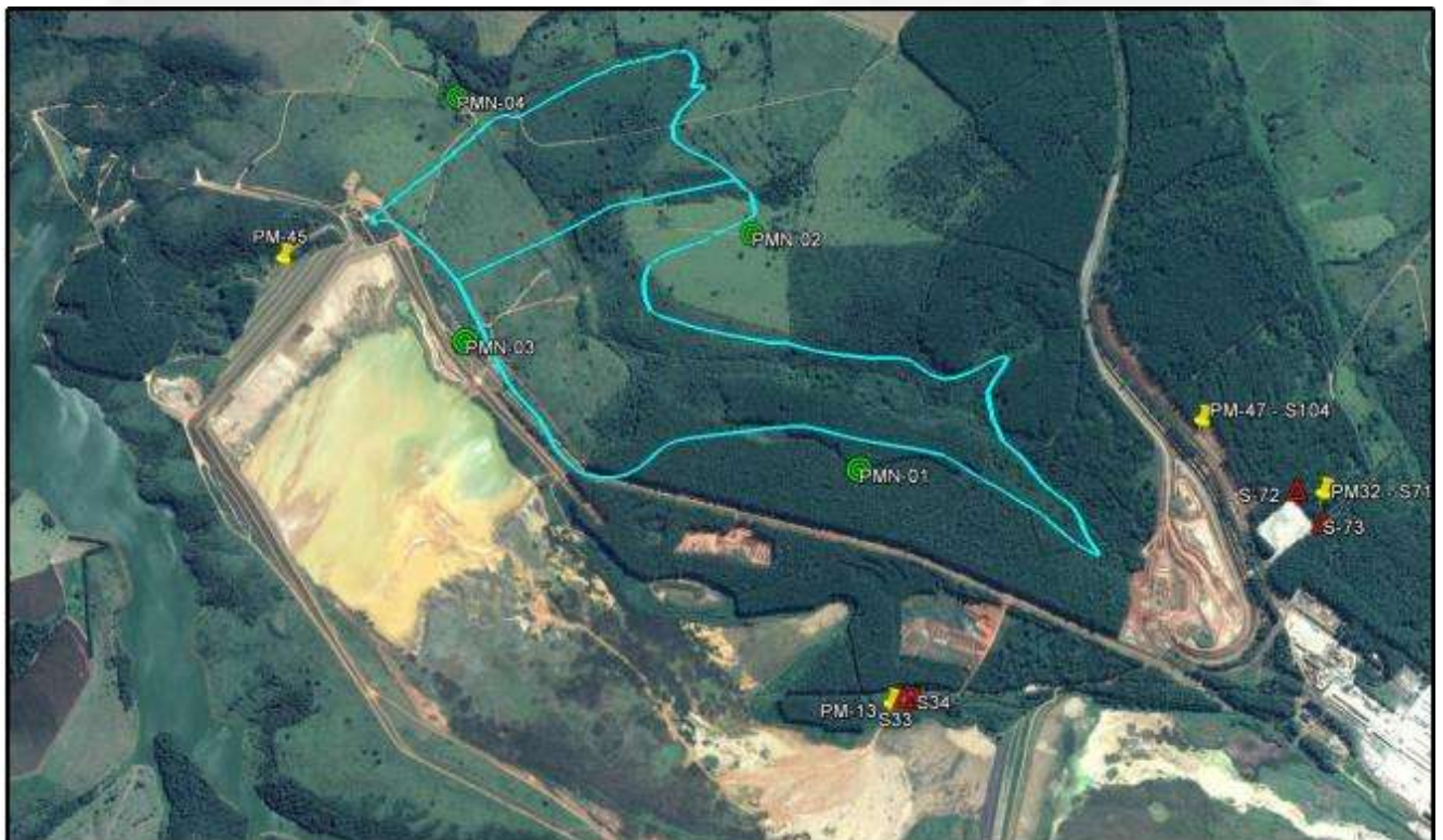
Figura 2 - Poços de monitoramento existentes (pinos amarelos), limite da barragem B6 em azul ciano, sondagens em triângulos vermelhos e poços de monitoramento propostos, representados pelos círculos verdes.
