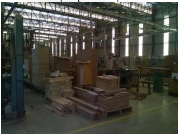
Foto 3. Setor de produção. Todas as máquinas estão conectadas ao sistema de exaustão.
