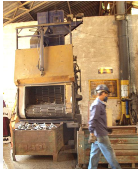
Foto 6: Jato de granalha em atividade.
