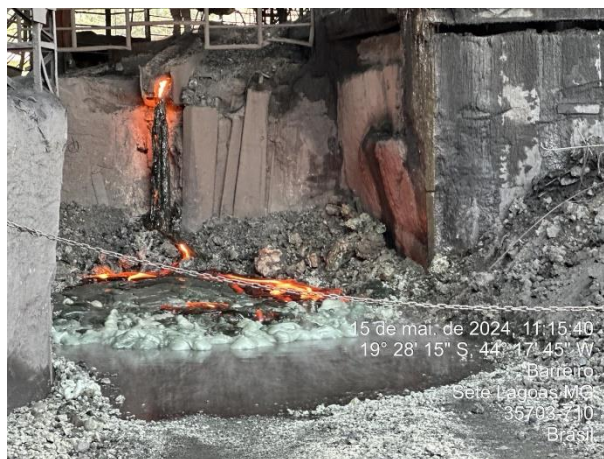
Foto 64: Detalhe da escória saindo na bica.
