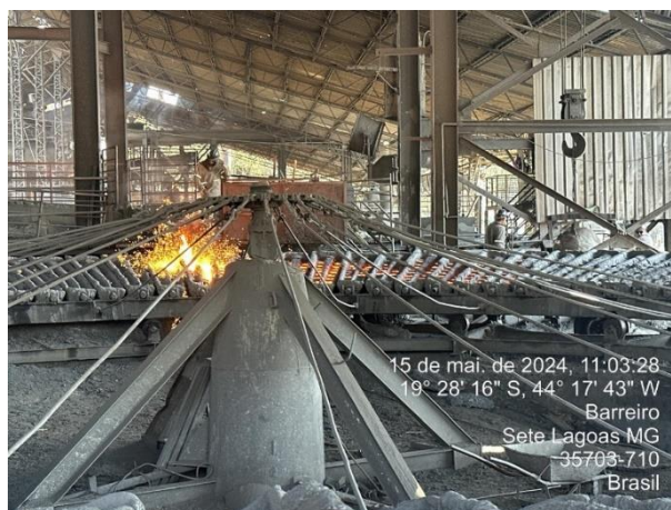
Foto 60: Gusa sendo despejado para fabricação dos lingotes.
