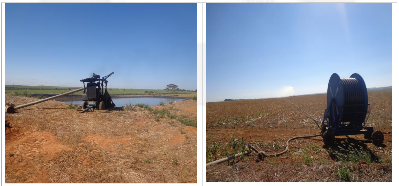
Figura 02 – Sistema de aplicação de dejetos de suínos.
