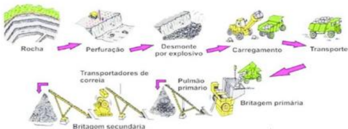
Figura 04: Fluxograma do processo produtivo. Fonte: EIA/RIMA
