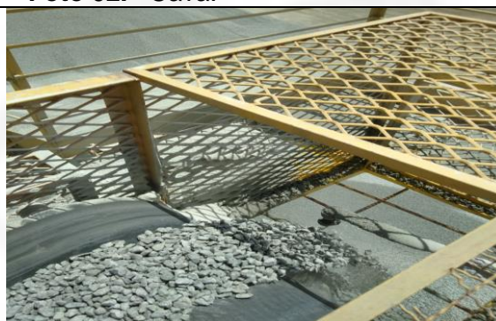
Foto 04. Aspersão de água na correia, saída do britador
