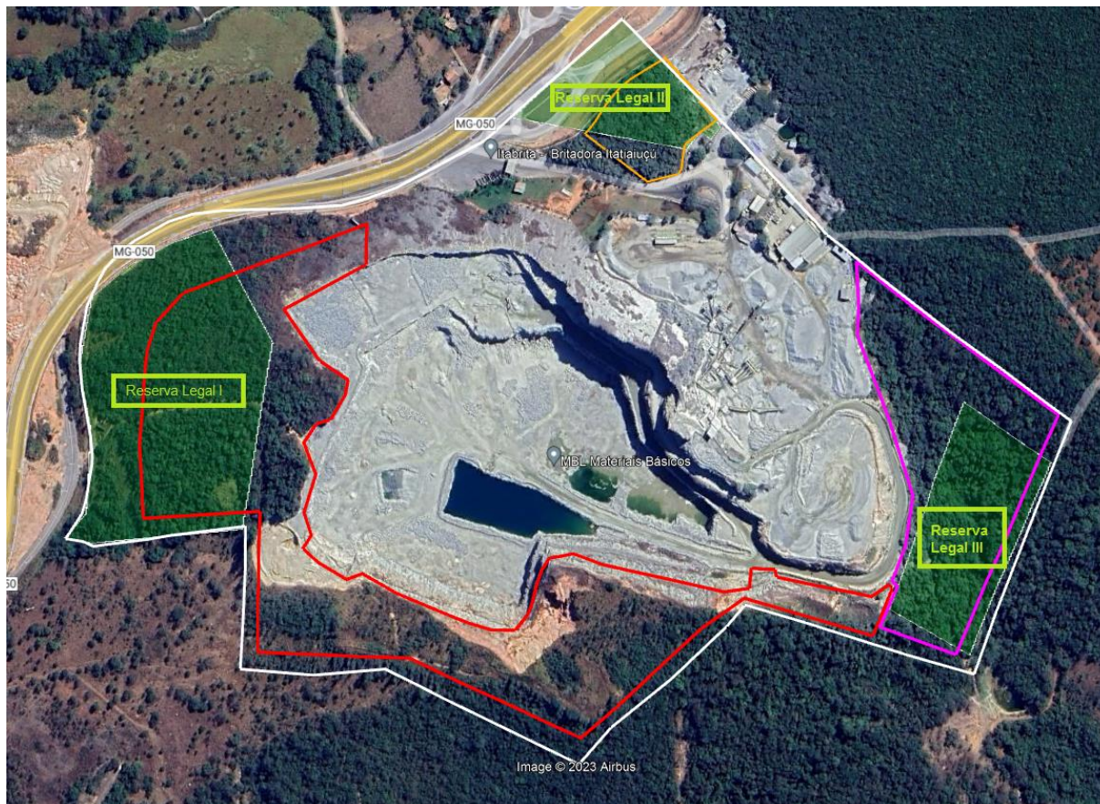
Figura 12: Áreas requeridas para intervenção – Avanço de lavra (vermelho); DCE (laranja), pilha de estéril (roxo); Reserva Legal anteriormente à relocação (verde). Fonte: Informação Complementar.
