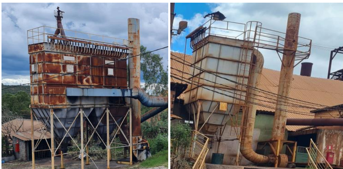
Figura 21. Filtro de mangas de carvão do forno 01 (Esquerda). Filtro de mangas de carvão do forno 02 (Direita).
