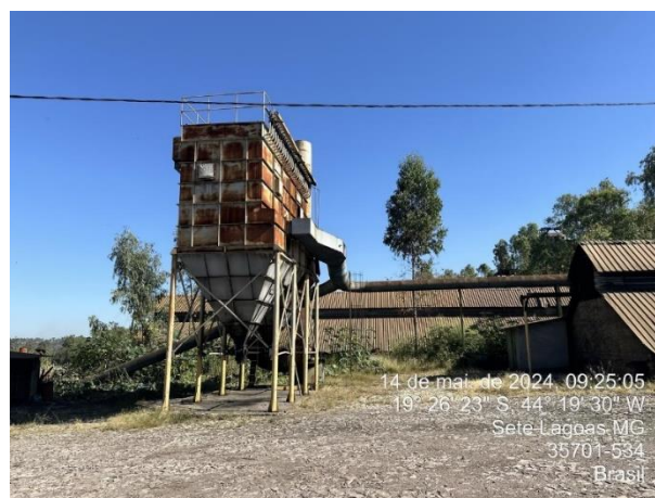
Foto 62: Filtro do peneiramento e descarga de carvão do alto-forno 01.
