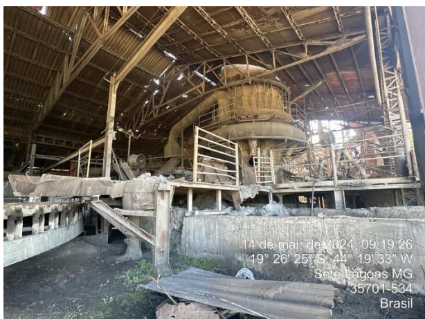
Foto 1: Estrutura do alto-forno 01, podendo observar avarias nas telhas e estruturas necessitando de reparos
