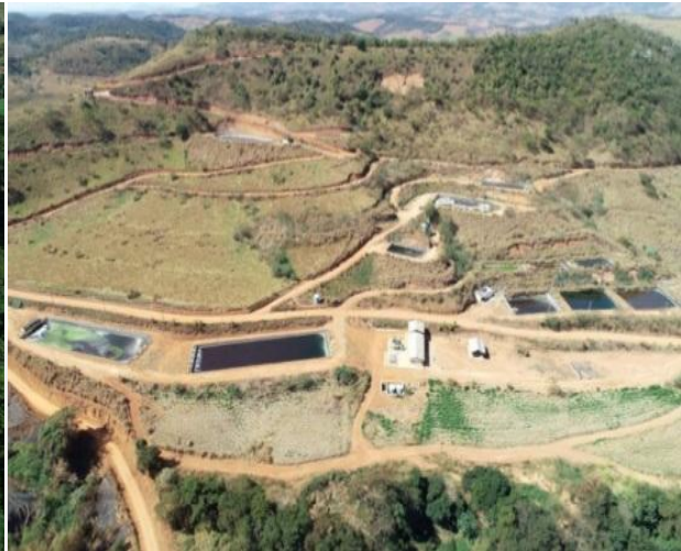
Foto 05 e 06: alguns dos biodigestores e algumas baterias de lagoas da Fazenda São Joaquim.
