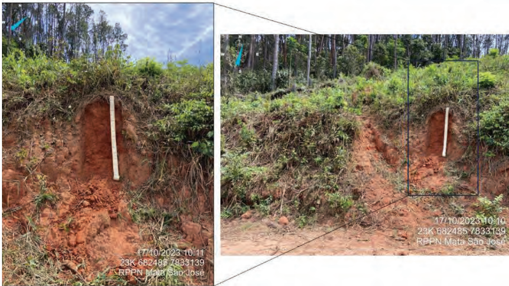
Foto 4-38 Perfil de LATOSSOLOS na porção oeste, circunvizinha à RPPN Mata São José.
