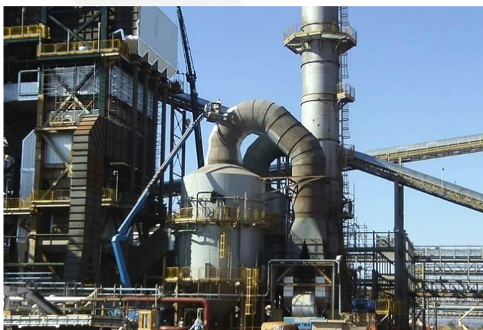
Caldeira com sistema de lavador de gases.
