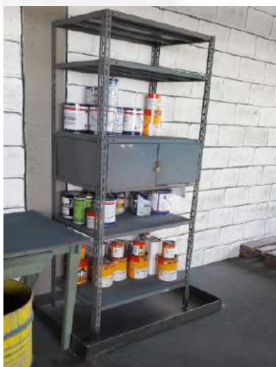
Figura 09: Bandeja para contenção na área de pintura.
