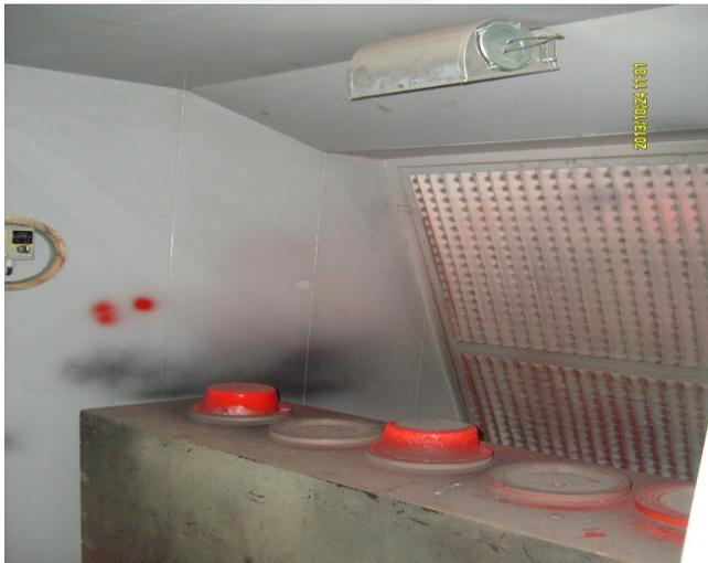
**Foto 7:** Cabine de pintura do sistema de injeção.
