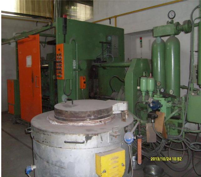
**Foto 5:** Equipamento do sistema de injeção
