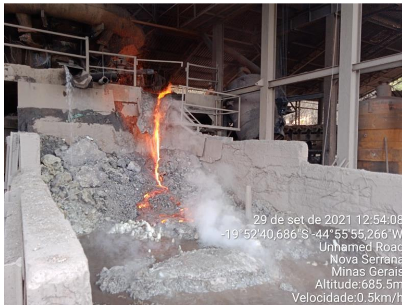
Fonte: Informação Complementar SIDERCAM. Foto 07: Escória na baía em resfriamento (após a vazão)
