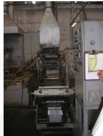
Foto 04. Forno para produção de grades.
