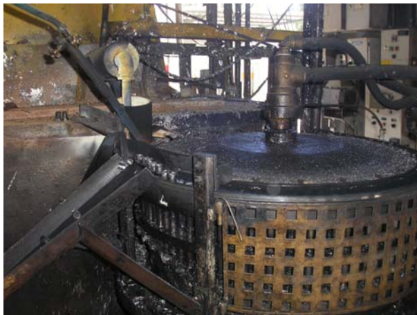
Foto 05. Forno para produção de cilindros de chumbo (que será reutilizado para produção de óxido de chumbo).
