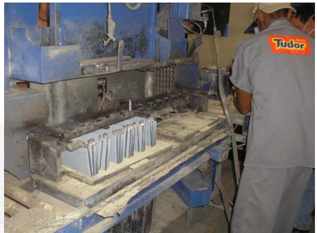
Foto 06. Produção das células de baterias
