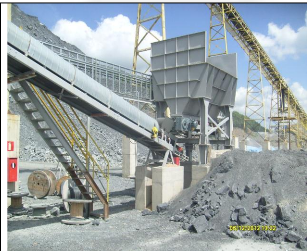
Foto 01: Matéria prima chega à área de moagem por meio de correias transportadoras.
