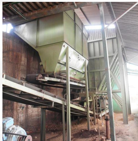
Foto 02. Dosador de pó de balão e silo de argila.
