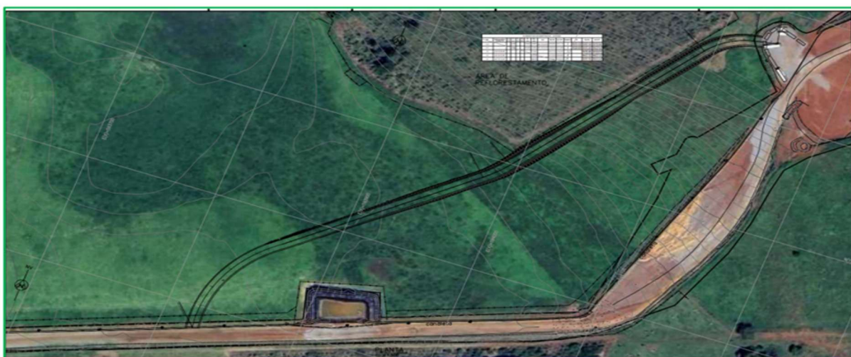
FIGURA 1: Representação do traçado projetado para o acesso alternativo que partirá da UTM 1 e se encontrará com a estrada de serviço preexistente. A concepção do traçado considerou afastar o leito estradal do Maciço Escrivânia, evitando ainda interferência com a área de reflorestamento compensatório. Fonte: SANDRA MINERAÇÃO, 02/06/2025 – adaptado.
