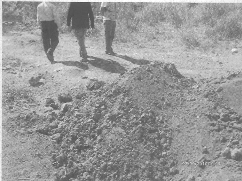
Imagem 06: Armazenamento inadequado de escória
