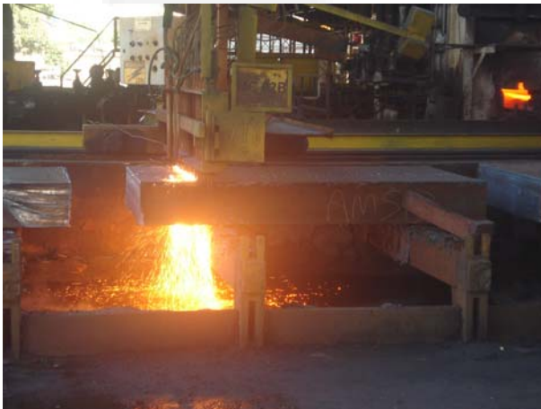
Figura 3: Corte de placas
