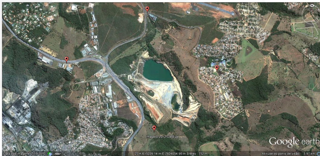
Imagem 02: Detalhe da imagem anterior, demonstrando toda a ADA do empreendimento, zonas urbanas próximas e morfologia da área cárstica (baixa rede de drenagem superficial e infiltração no subsolo através de dolinas) e pontos de monitoramento sismográfico (em vermelho).
