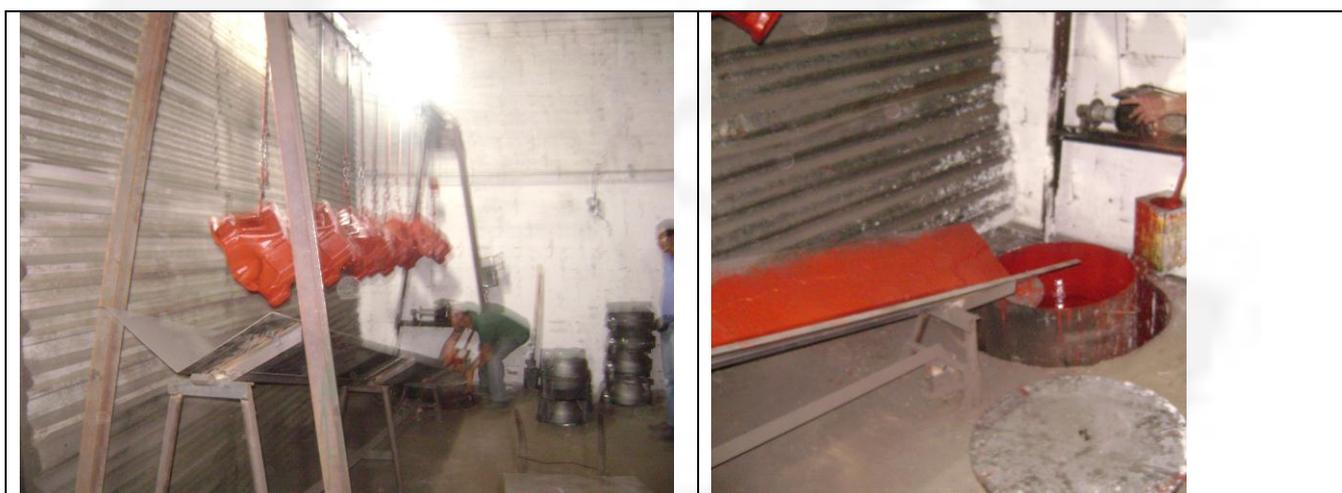
**Foto 06.** O sistema de pintura por imersão em local impermeabilizado, onde as peças depois de pintadas são penduradas e os respingos são captados por “canaletas”.
