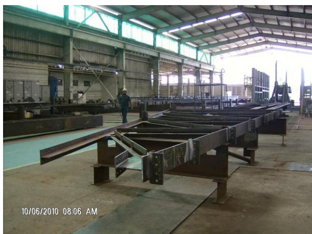
Foto 01. Montagem de Vagões
