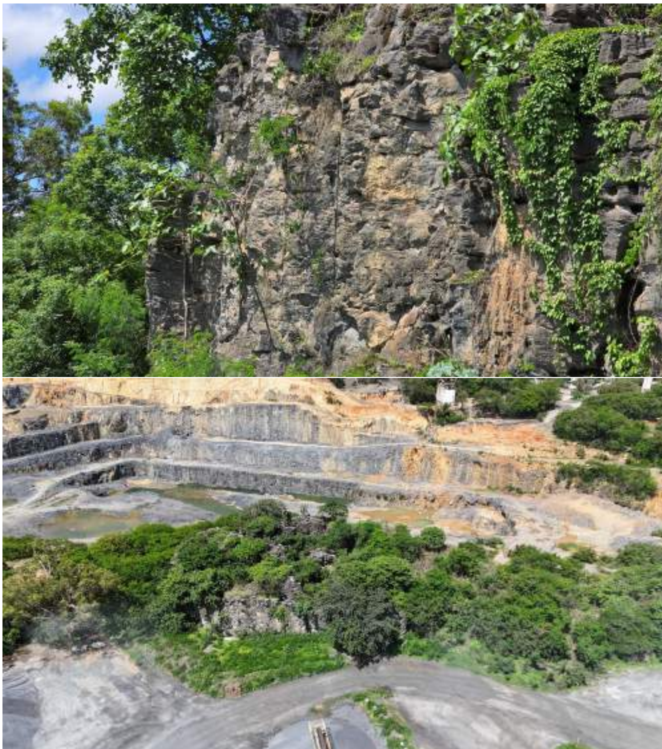
Figura 2.4-6 Afloramento de calcário calcítico próximo à ocorrência das cavidades e área da cava com camada no topo correspondente à cobertura pedológica.
