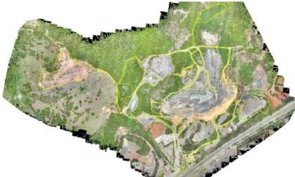
Figura 3: Sobreposição em SIG da ortofoto com a ADA em escala 1:5.000.
