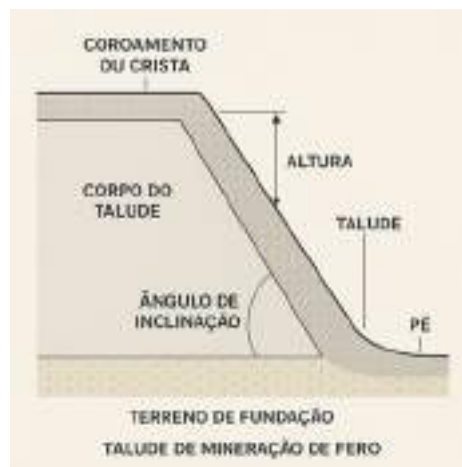
Figura 2: Desenho esquemático para sistematização do talude.
