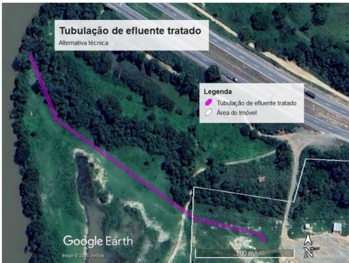
Figura 14. Traçado da área de instalação de tubulações para lançamento de efluentes líquidos industriais tratados.
