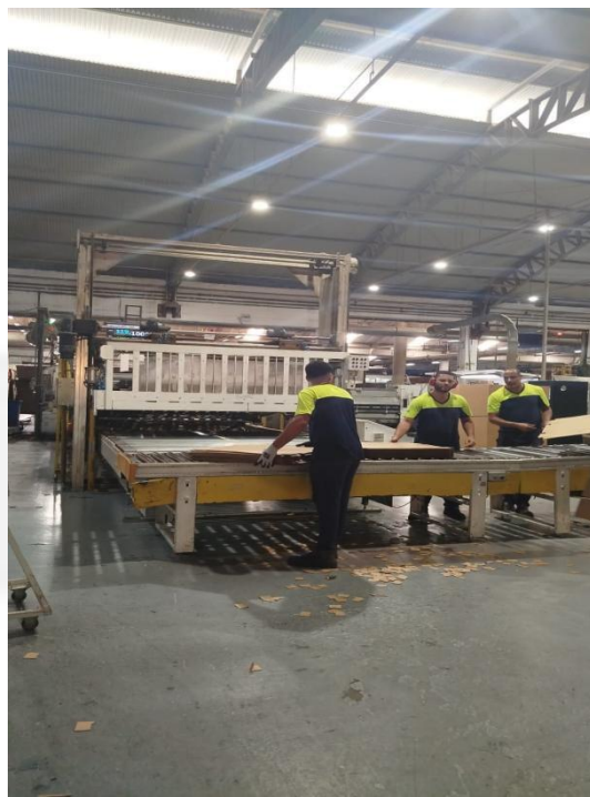
Corte das caixas
