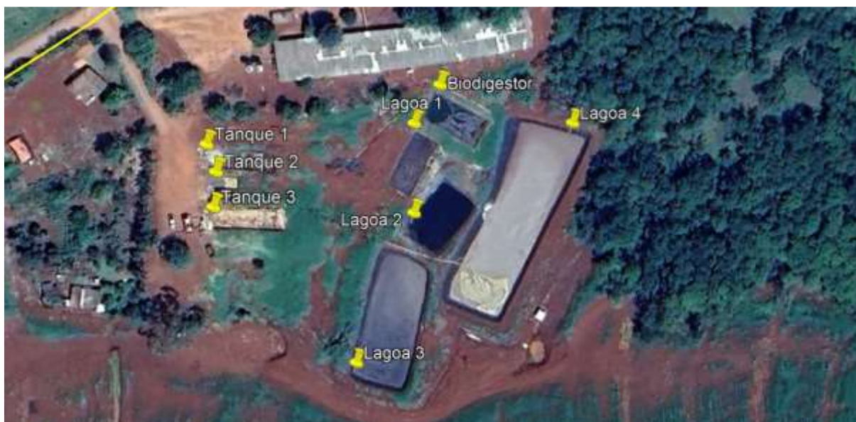
Figura 2- Imagem de satélite com a identificação das estruturas utilizadas para o tratamento dos efluentes no empreendimento. Fonte: RADA (BR GESTÃO DE RESÍDUOS, 2025)
