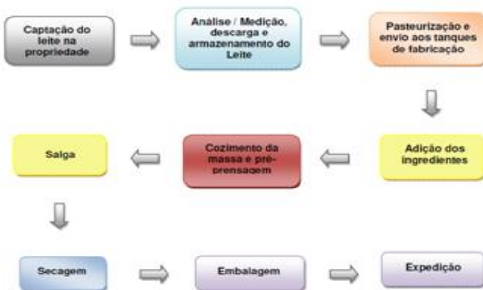
Figura 1: Fluxograma do processo industrial. Fonte: RADA
