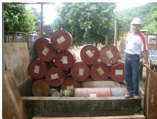
Foto 04. Tambores de Armazenagem de Efluentes Oleosos
