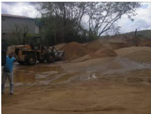
Foto 01. Pátio de estocagem, as pilhas secando e sendo carregadas por pá carregadeira em caminhões lonados.
