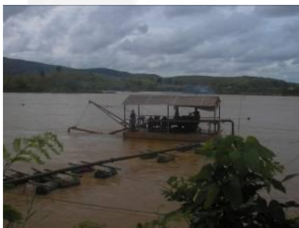
Foto 03. Draga utilizada para extração de areia.
