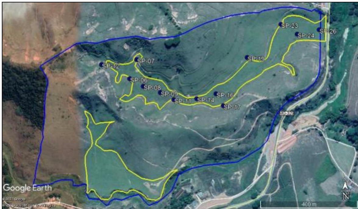
Figura 4: Furos SP nos quais o nível d'água do lençol freático foi detectado na área da CTR Bituruna.
