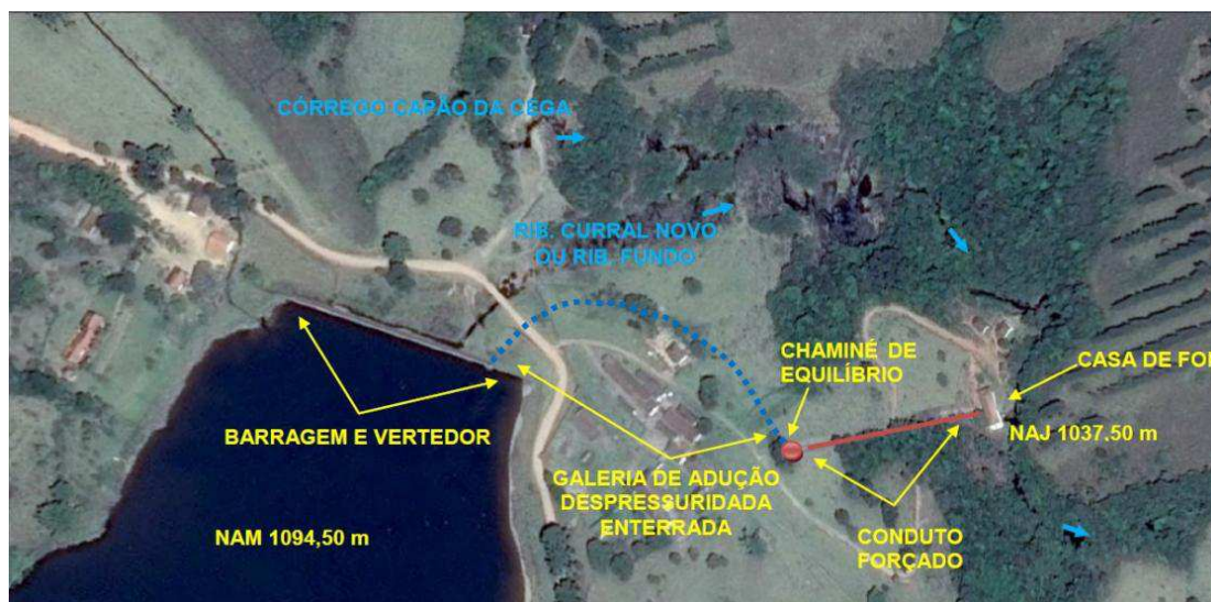
Figura 02: Arranjo geral. Fonte: RCA.
